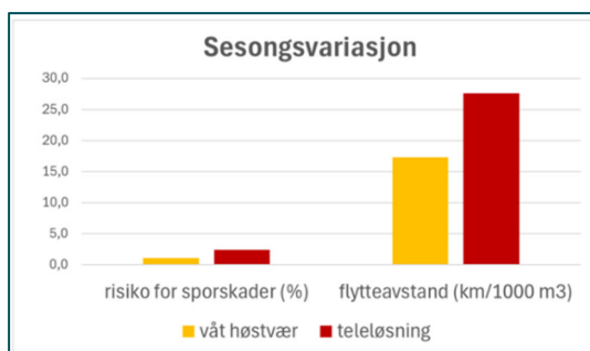
Figur 5. Sammenligning av risiko for sporskader (venstre) og flytteavstand mellom drifter (høyre) mellom høstvær og teleløsning.
